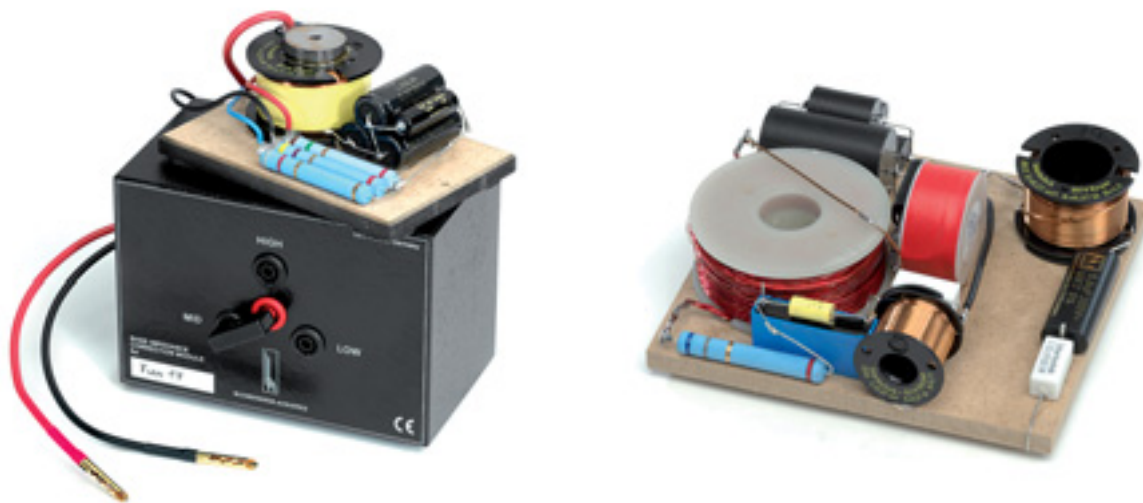
Links: Die Impedanzkorrektur für Bass- und Grundtonlagen kommt im Extra-Kästchen und kostet Extra-Geld. Rechts: Markenbauteile tummeln sich auf der Frequenzweiche, die eine eigene Kammer hinter der Schallwand bewohnt
