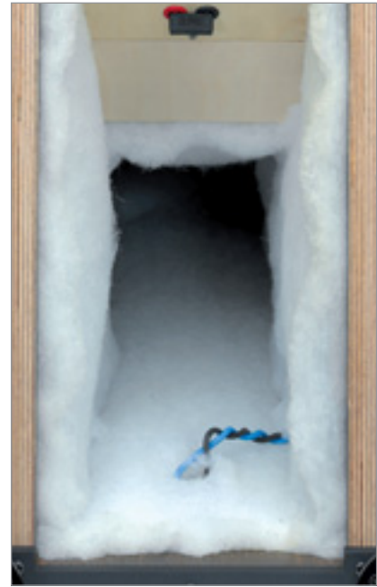
Oben im Bild: Impedanzkorrekturbrücke. Rundherum: Dämmstoff im Hornverlauf
